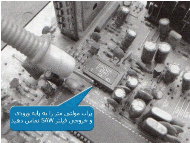
شکل ۱۱-۲ تماس پراب مولتی متر با پایه ورودی و خروجی فیلتر SAW
