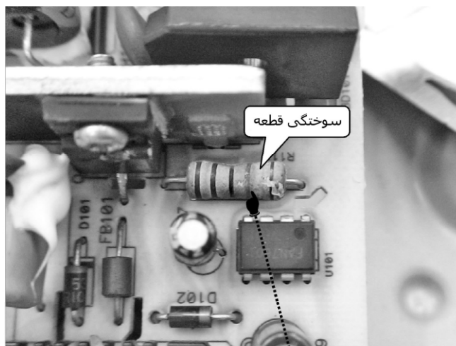
ببینید پایه های قطعات روی برد مدار قطعی دارد یا روی بدنه آنها علائمی از سوختگی مشاهده می شود.
