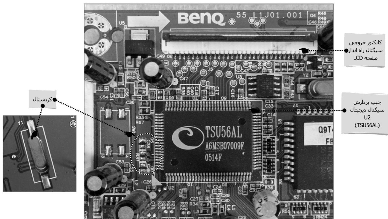
شکل ۲-۵ ساختار پایه ای مدار پردازش سیگنال دیجیتال در یک نمونه مانیتور LCD (BenQ Q9T4)
