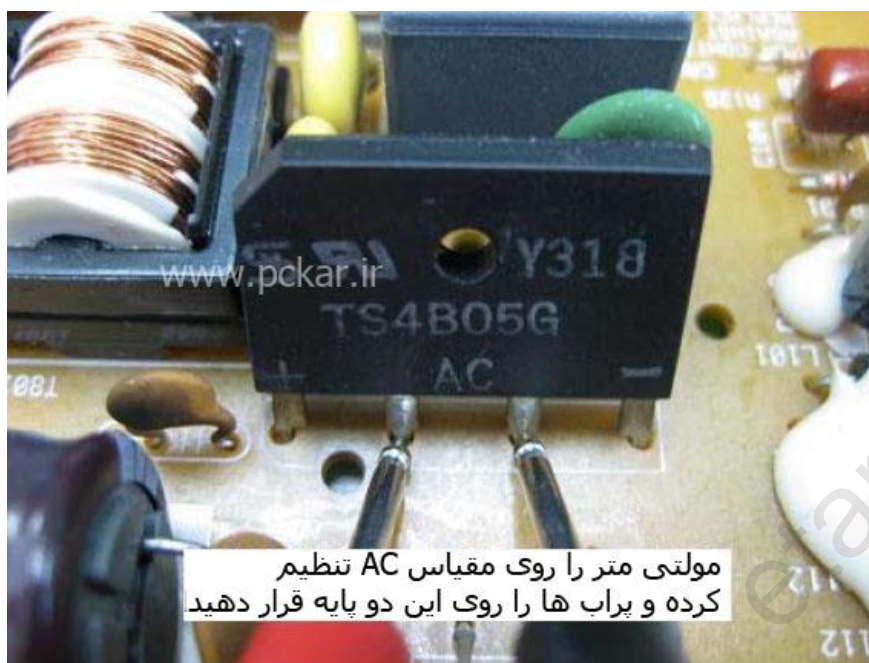
شکل ۱۱.۲ - پراب ها را در نقاط صحیح قرار دهید
