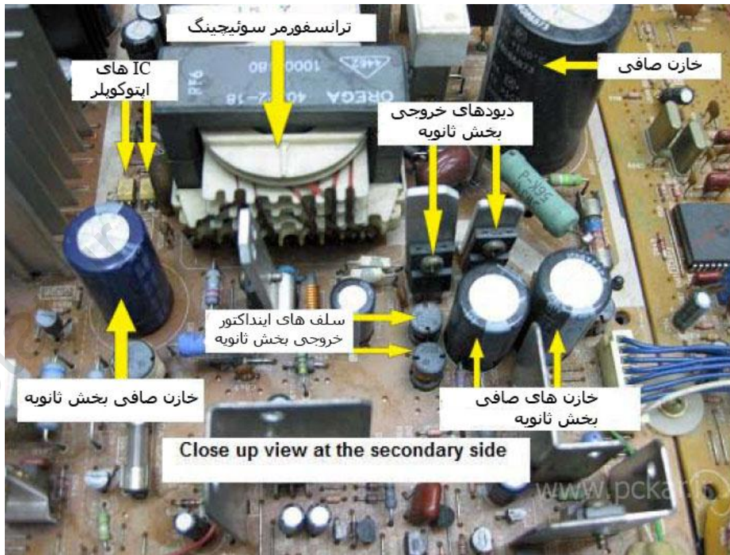
شکل 2.4 – SMPS تلویزیون CRT Sony
