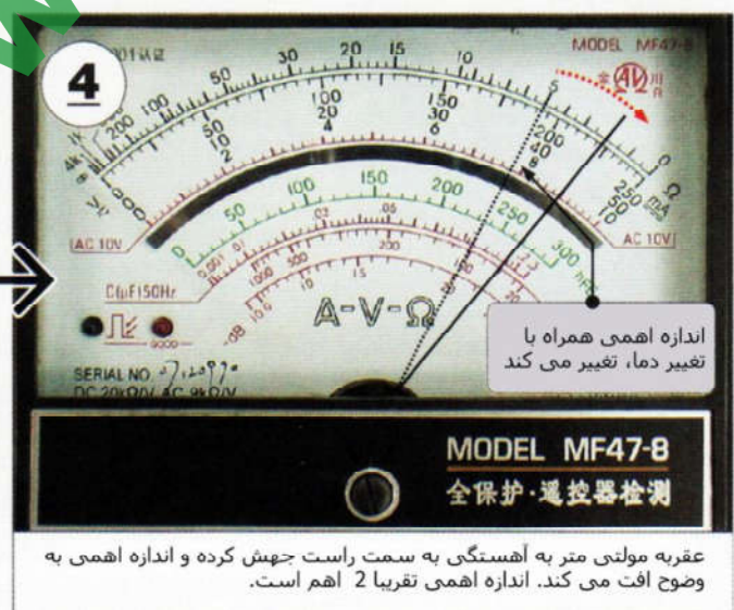
شکل ۳۵-۵ نحوه تست ترمیستور
