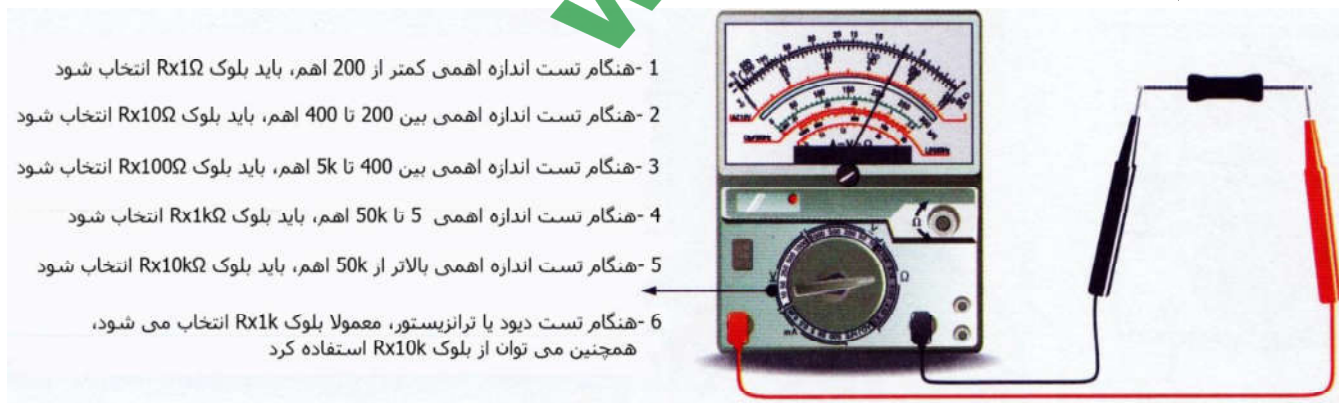
شکل ۱۷-۱ انتخاب رنج هنگام به کارگیری مولتی متر عقربه ای برای تست اندازه اهمی
