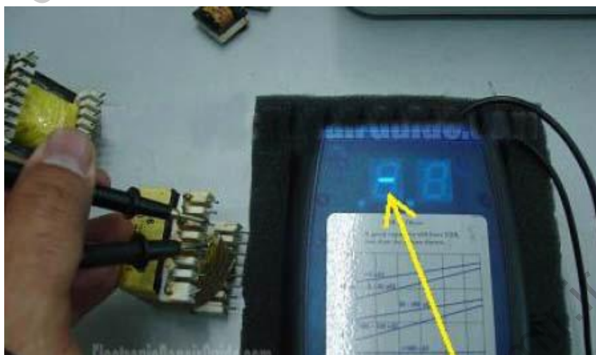
بخش اولیه سیم پیچ ترانس سالم نباید هیچ قرائتی داشته باشد
