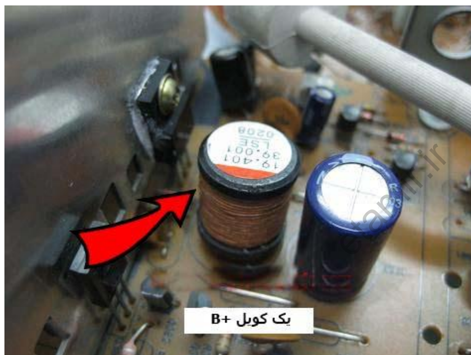
۲. آزمایش کویل B+ در مانیتور CRT
